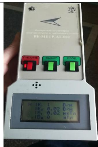
**Рисунок 3** – Прибор измерения ЭМИ BE-METP-AT-002
