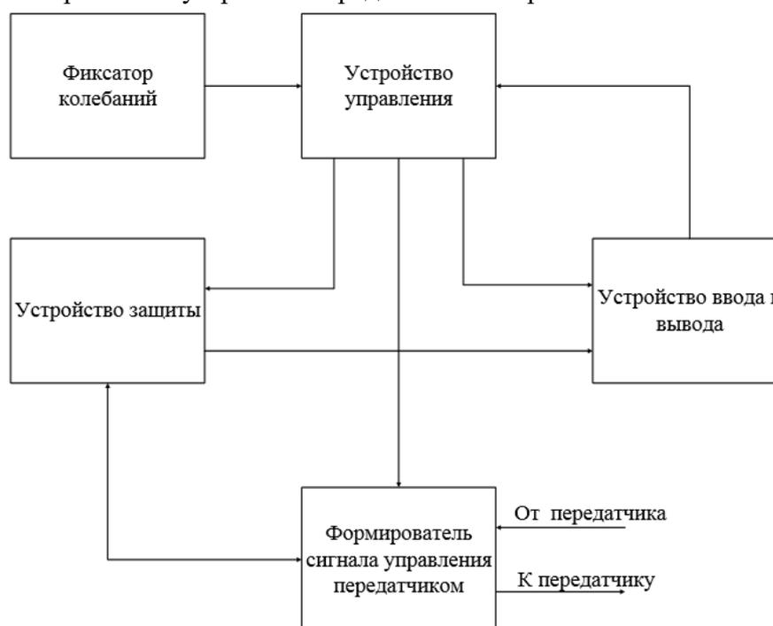
**Рисунок 1** – Структурная схема устройства коррекции диаграммы направленности
