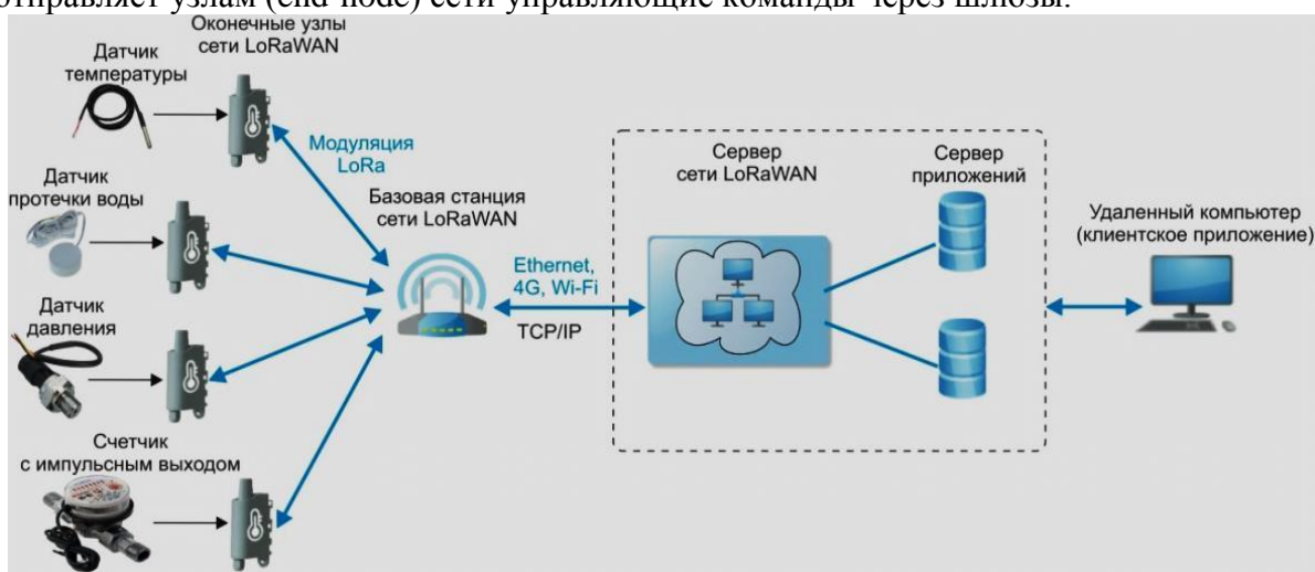
Рисунок 3 - Типовая архитектура сети LoRaWAN
