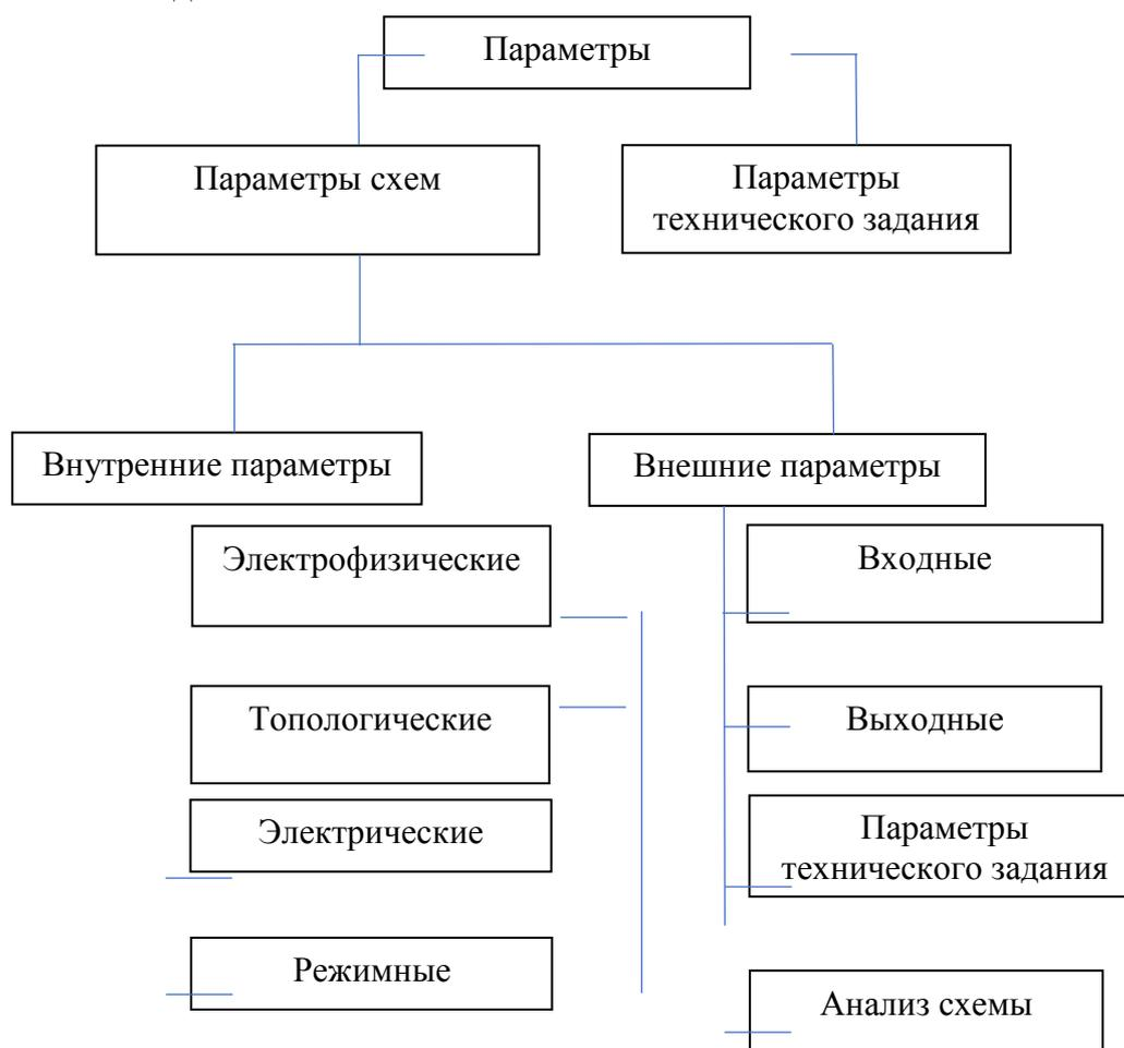
**Рисунок 1** - Классификация параметров радиоэлектронных устройств
