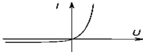
Рисунок 25 - Статическая характеристика диода
