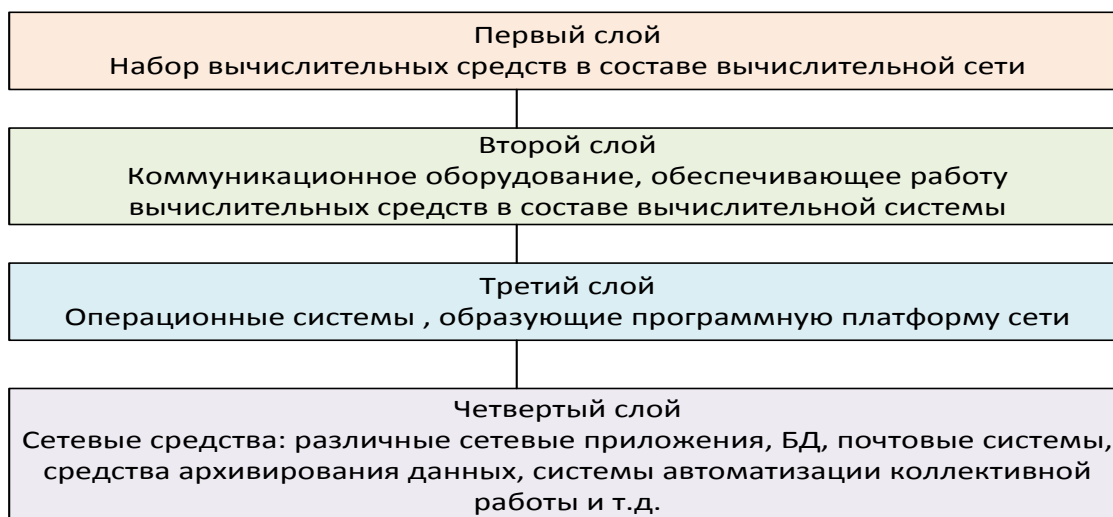
Рисунок 2 – Системная архитектура распределенной вычислительной системы
