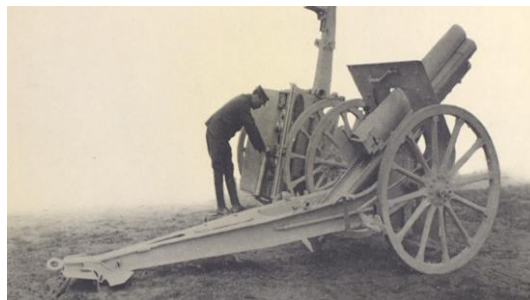
Рисунок 22 – Полевая гаубица О.С.48''''. Калибр 121,92 мм (фирмы «Шнейдер» образца 1910 года)
