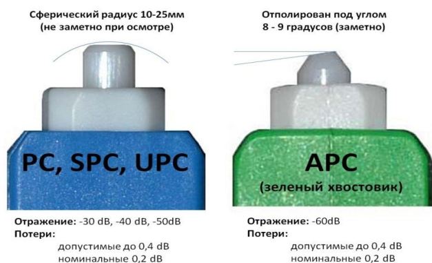
Рисунок 4 – Сравнение внешнего вида разъемов с полировками UPC и APC
