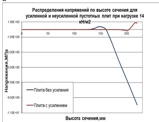
Рисунок 7 а - Распределения напряжений по высоте сечения для усиленной и неусиленной пустотных плит при нагрузке 14 кН/м 2 ;
