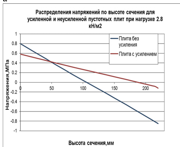
Рисунок 6 а - Распределения напряжений по высоте сечения для усиленной и неусиленной пустотных плит при нагрузке 2.8 кН/м 2 ;
