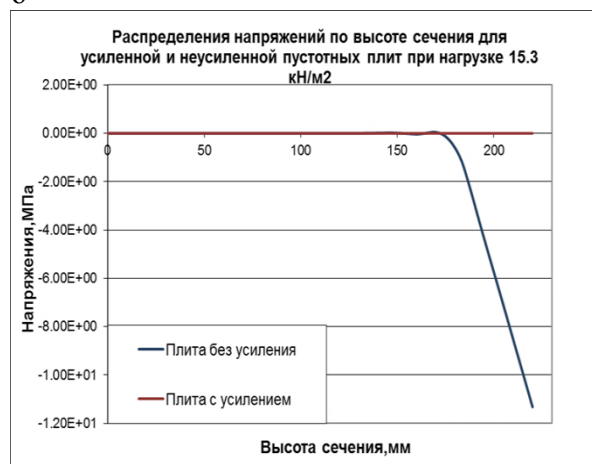
Рисунок 7 а - Распределения напряжений по высоте сечения для усиленной и неусиленной пустотных плит при нагрузке 14 кН/м 2 ;
