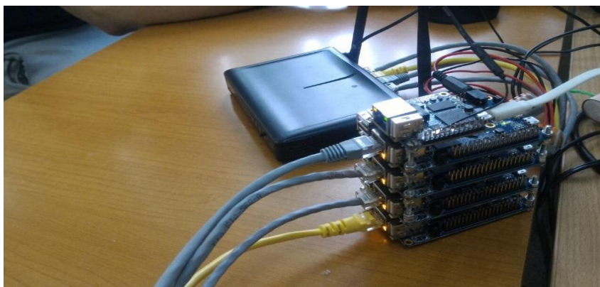
Рисунок 1 – Кластерная система на основе Orange Pi
