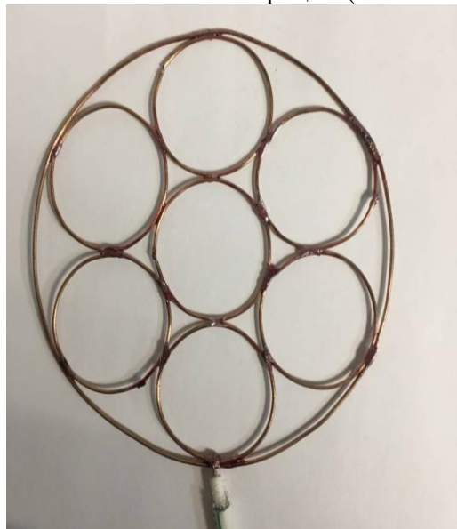
Рисунок 2 – Кольцевая фрактальная антенна первой итерации
