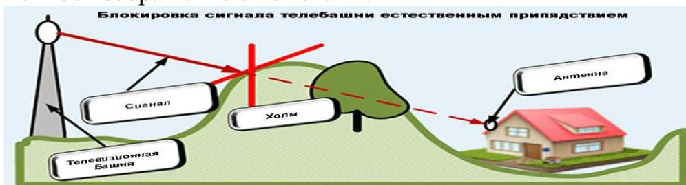
Рисунок 3 – Возможные блокировки сигнала в аналогово телевидения.
