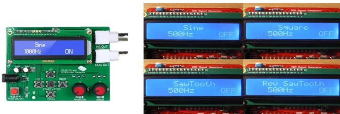
**Рисунок 2** – Вид генератора «С-Тест» и примеры отображения различных видов сигналов на ЖК-дисплее
